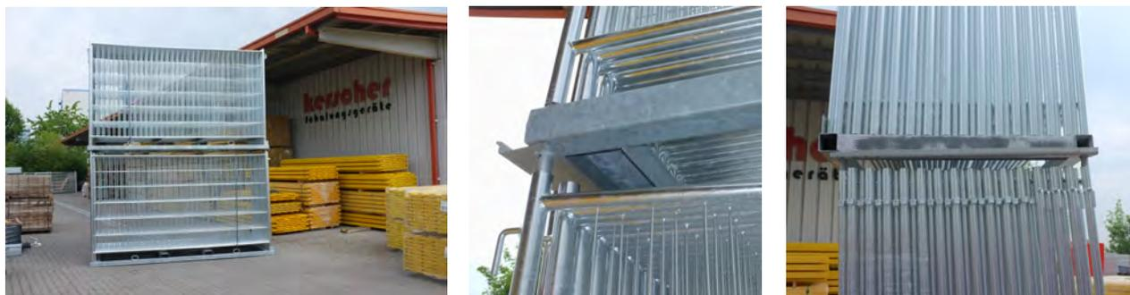
→ **Bauzaun-Ständerpalette (Art.-Nr: 15-211)** ideal zum sicheren Transport bzw. Lagern von 30 Stück Bauzaunelementen (Art.-Nr: 15-200); Die Elemente werden einfach stehend auf die Aufnahmezapfen aufgesteckt; 2 Gabelführungen für Stapler bzw. 4 Kranösen sind zum einfachen Handling bereits vormontiert. Zwei Paletten davon passen auf der LKW-Ladefläche optimal aneinander. Dies ist ein Vorteil gegenüber den schmalen Paletten (nur 25 Elemente) von einigen Wettbewerbern.
