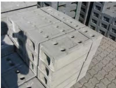
→ **Betonfuß (Art.-Nr: #15-203)** als Fußteil zu allen Bauzaunelementen passend. Mit eingearbeiteter Gitterdrahtarmierung; mit 36kg extrem gute Standsicherheit. Dies ist besonders wichtig, wenn die Bauzäune mit Werbungen oder Sichtschutz bespannt werden - wegen der höheren Windlast - damit der Bauzaun nicht kippt. Abmessungen: 69,5 x 19 x 13cm (L x B x H).
