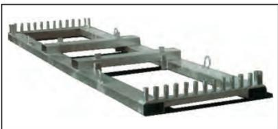
→ **Bauzaun-Ständerpalette (Art.-Nr: 15-211)** ideal zum sicheren Transport bzw. Lagern von 30 Stück Bauzaunelementen (Art.-Nr: 15-200); Die Elemente werden einfach stehend auf die Aufnahmezapfen aufgesteckt; 2 Gabelführungen für Stapler bzw. 4 Kranösen sind zum einfachen Handling bereits vormontiert. Zwei Paletten davon passen auf der LKW-Ladefläche optimal aneinander. Dies ist ein Vorteil gegenüber den schmalen Paletten (nur 25 Elemente) von einigen Wettbewerbern.
