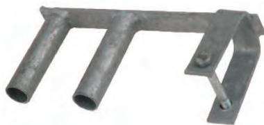
→ **Tordrehgelenk (Art.-Nr: #15-206)** zum einfachen Erstellen eines 1 oder 2-flügligen Tores; passt an alle gängigen Standardelemente. Wird oben in das seitliche Standrohr des Zaunelementes eingesteckt.
