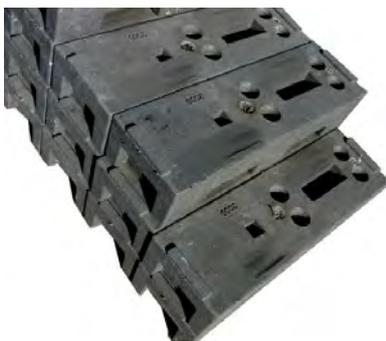
→ **Recycling (Art.-Nr: #15-203)** passend zu allen Bauzaunelementen Mit 6 Einstecklöchern und 2 seitlichen Griffmulden zum Tragen. Aus schlagfestem und unzerbrechlichem PE-Material. Integriert sind 2 Ausparungen zum Einfahren von Gabelstaplerzinken zum einfachen und schnellem Be- und Entladen bzw. Transport. Abmessungen: 77 x 24,4 x 15cm (L x B x H). ca. 18kg.
