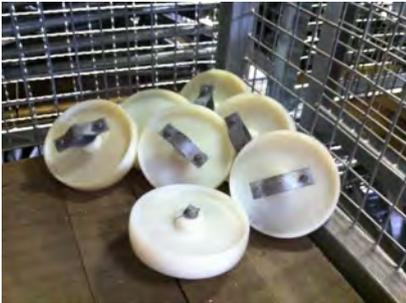
→ **Torrolle (Art.-Nr: #15-209)** zum einfachen Öffnen und Schließen einzelner Bauzaunelemente beispielsweise als 1 oder 2-flügeliges Tor. Wird einfach an das Fußteil des seitlichen Standrohrs angeschraubt. Gut in Verbindung mit unserem Tordrehgelenk #15-206. Stabiles, witterungs- und UV-beständiges Hart-PE-Material. Durchmesser 19,5cm.
