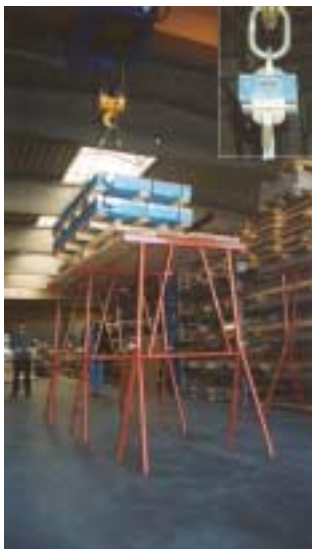
GS-Prüfung von Gerüstböcken mit 3facher Sicherheit (4.800kg!)
