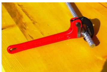
Schnelles Drehen durch selbstspannende Feder Einsatz wie bei Ratsche ...
