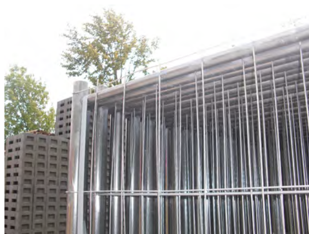
rundum geschweißte Querrohre
