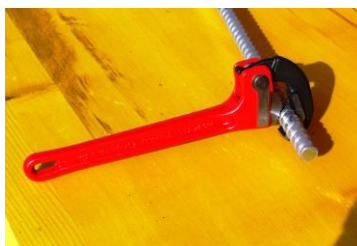
Schnelles Drehen durch selbstspannende Feder Einsatz wie bei Ratsche ...
