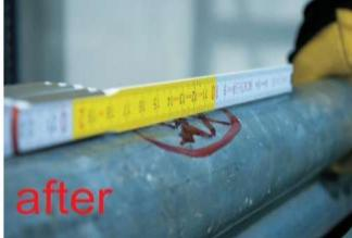
5.2. Wenn die inneren und äußeren Rohre beim Herumschleichen oder beim Drehen klemmen, muss man die Stellen der Beulen neu feststellen und die Reparaturarbeiten zu wiederholten Malen machen.
