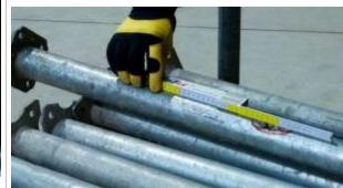
1.3. Messen Sie den Durchmesser des Loches mit dem Messschieber(190.050) ab, messen Sie den Abstand mit dem Lineal (190.060) bis zur weitesten Verletzung aus.
