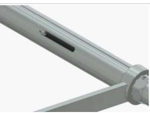
3.2. Den vorderen Teil des Verlängerungsstücks ziehen Sie auf den sechseckigen Teil des Korpus vom Hauptwerkzeug darauf so, dass die Längsrillen von beiden Teilen in einer Linie wären.
