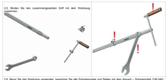
2.6. Bevor Sie das Werkzeug verwenden, bespritzen Sie alle Schmierpunkte und Stellen mit dem Aerosol – Schmiermittel (190.040). Das Gleiche machen Sie immer nach 30-50 Arbeitszyklen.
