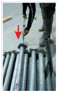
4.5. Beim Festhalten mit dem kombinierten Inbusschlüssel drehen Sie den Griff nach dem Uhrzeiger. Drehen Sie so lange bis der Indikator des Werkzeuges das Ende erreicht (er wird ganz rot) oder bis die Rotationskraft größer wird.
